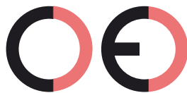
Virheellinen CE-merkki (liian kaukana)
